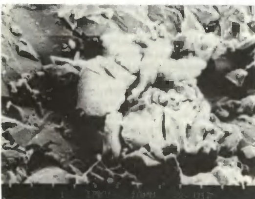
Вскрытая межфазовая граница (межзеренный излом) железо-никелевого сплава: вверху — частицы оксидов алюминия, кремния, хрома; в середине — частицы фосфидов, сульфидов, оксидов алюминия, кремния. Расстояние между делениями — 3 мкм; внизу — в центре ядра частица выделившегося хромита ( \text{FeCr}_2\text{O}_4 ), мелкие включения — фосфиды. Расстояние между делениями — 10 мкм. Изображение получено на сканирующем электронном микроскопе Стереоскан-180.
