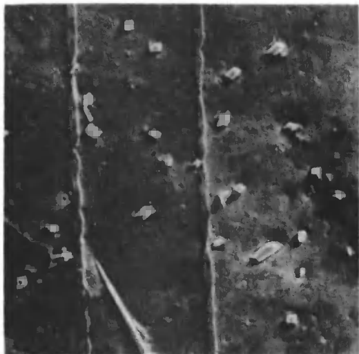
Равномерные выделения частиц избыточной фазы (нитридов) в хром-алюминиевом сплаве (увеличено в 300 раз).
